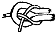
VUELTA DE ESCOTA. Para unir cuerdas del mismo o un diámetro grueso.
